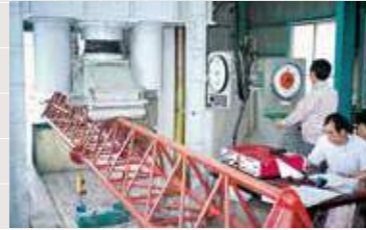
トラス曲げ試験
